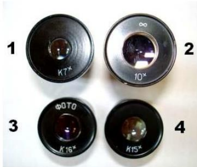
Şəkil 19. Okulyarların növləri: 1 və 4 – kompensasiya okulyarları; 2– Qeyqensin okulyarı; 3– kompensasiya fotookulyarı
