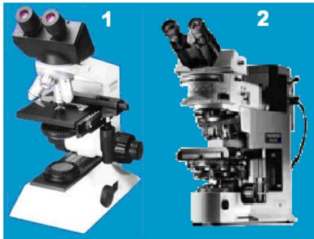
Şəkil 21. Qaranlıq sahə (1) və faza–kontrast (2) mikroskopları
