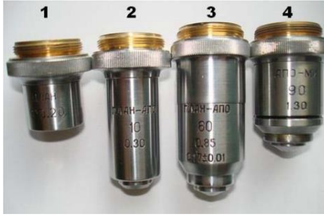
Şəkil 18. Mikroskopun obyektivləri: 1–planaxromat kiçik ölçüdə böyüdülmə üçün; 2 və 3 –planapoxromatlar; 4– immersion apoxromat
